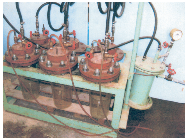
写真-1 透水試験状況
