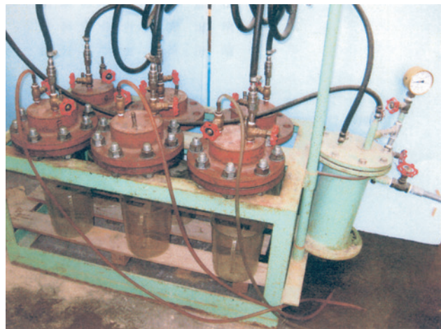
写真-1 透水試験状況
